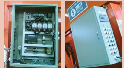
自動停止システム（過負荷時の自動逆転機能） 自動制御システム
