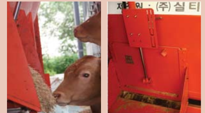
磁力選別器による異物の混入防止
